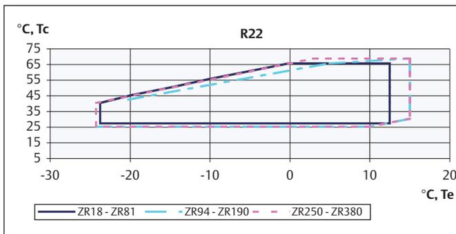
Te = Evaporating temperature / Température d'évaporation / Verdampfungstemperatur
